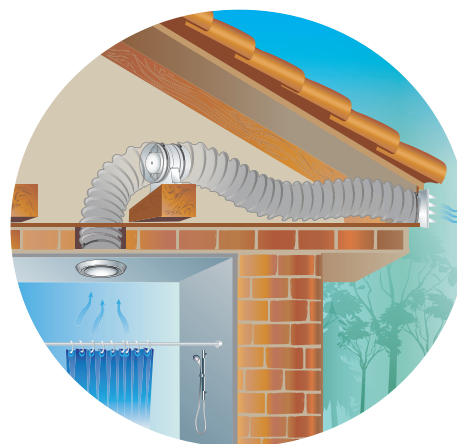
VKOk fan cottage ventilation example
