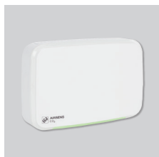
AIRSENS RF SABIK- CO2 NL Luchtqualiteit-sensor voor vraag-gestuurd ventileren. 230V voeding, draadloze communicatie i.c.m. ontvanger REC.AirSens. Tot 4 sensoren te koppelen op 1 SABIK-unit.
