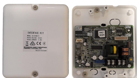
Interface koppeling SC-BIKN2-E t.b.v. bedrade bediening RAC-units
