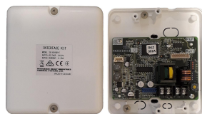
Interface koppeling SC-BIKN2-E t.b.v. bedrade bediening RAC-units
